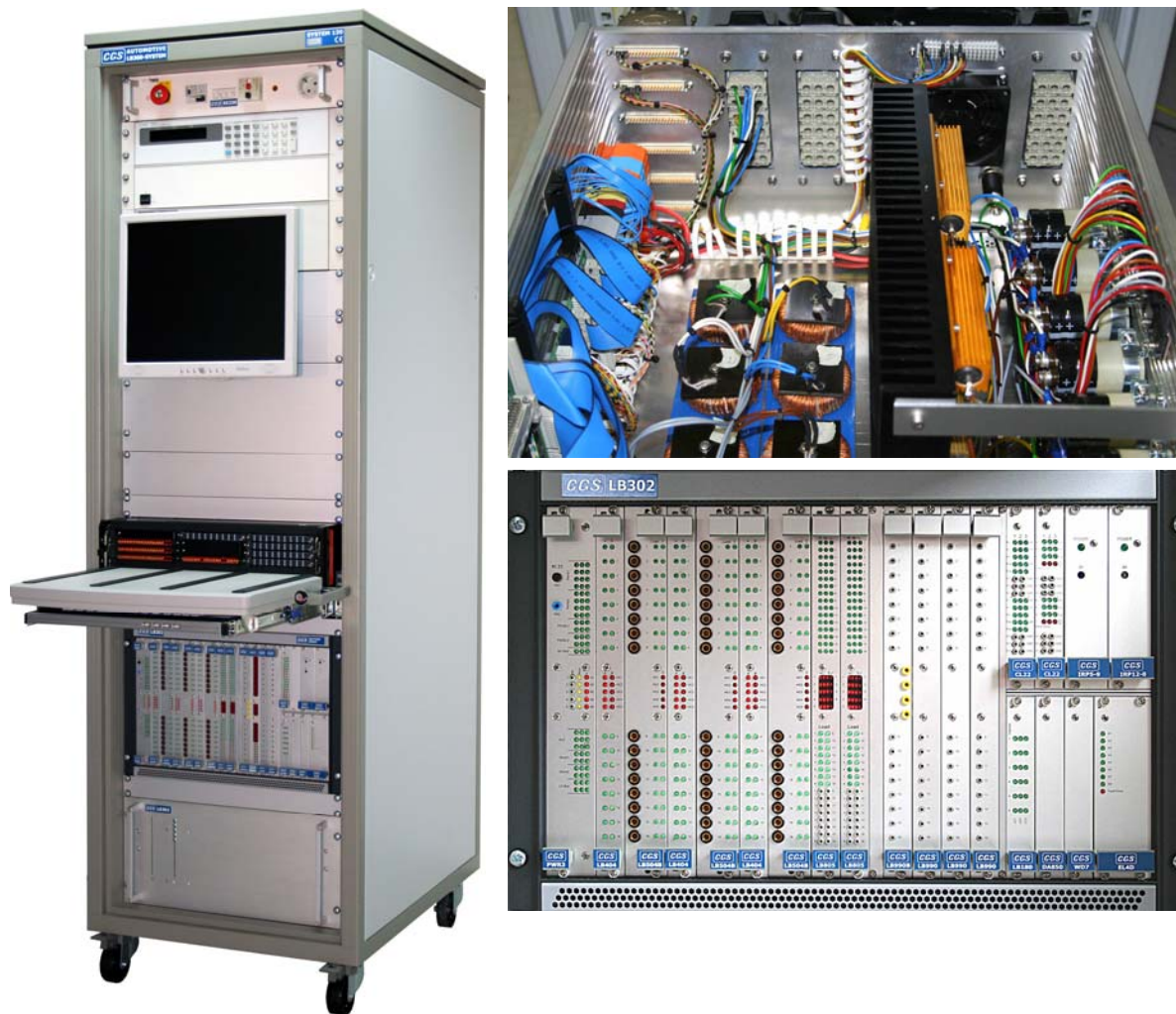
Abb. 108: Ein universell verwendbares, modular aufgebautes Endtestgerät (links), ein zugehöriger Lasteneinschub (rechts oben), ein als standardisiertes Baukastensystem ausgeführter Elektronik-einschub (rechts unten). Bildquelle: CGS – Computer Gesteuerte Systeme GmbH
