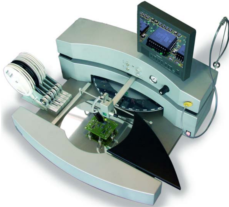
Abb. 75: Arbeitsplatz mit Kamera zur manuellen Bestückung von SMD-Bauelementen Bildquelle: DIMA Group B.V.
