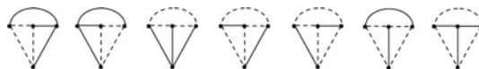
Abb. 8.27 Graph des Netzwerkes von Abb. 8.26 mit den sieben möglichen, verschiedenen Maschen (gestrichelt)
